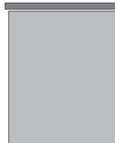
vorne/Seite Flachdach, horizontaler Abschluss leicht vorspringend
