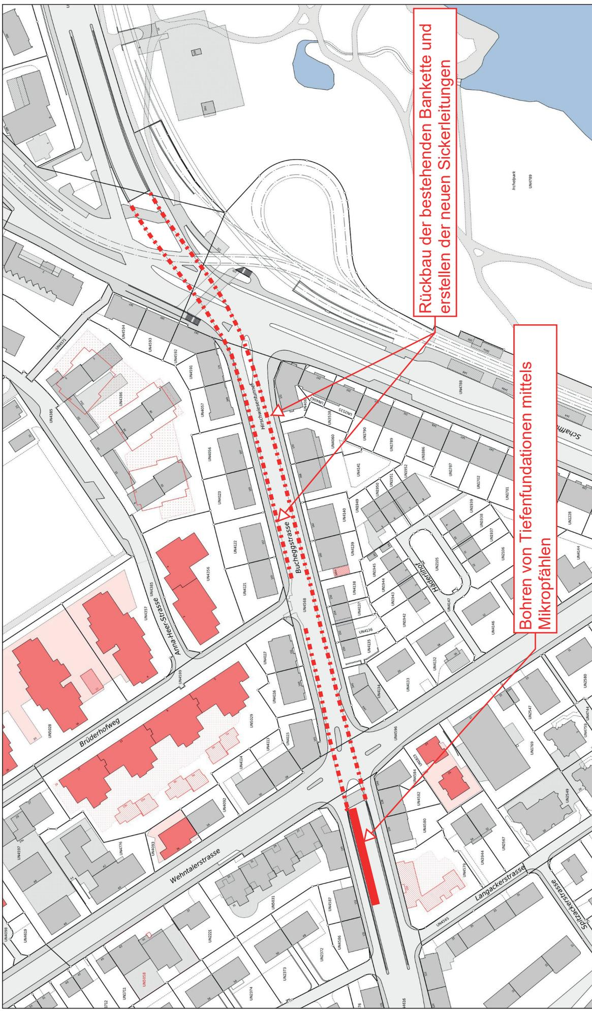
Rückbau der bestehenden Bankette und Erstellen der neuen Sickerleitungen
