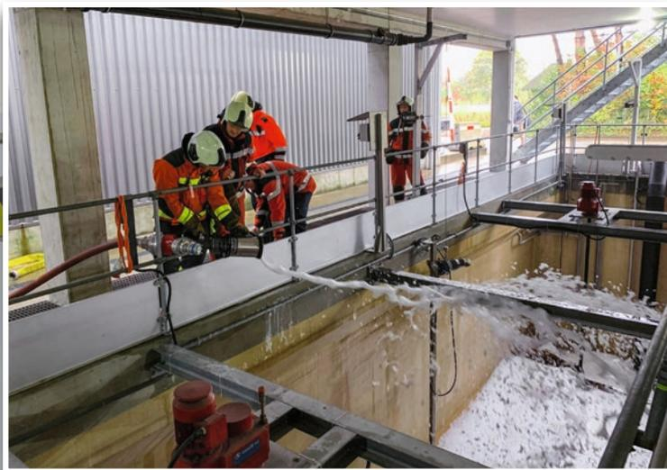
Die Messreihen zu taktischen Einsatzlängen für das Löschmittel Schaum zeigten erstaunliche Ergebnisse.
