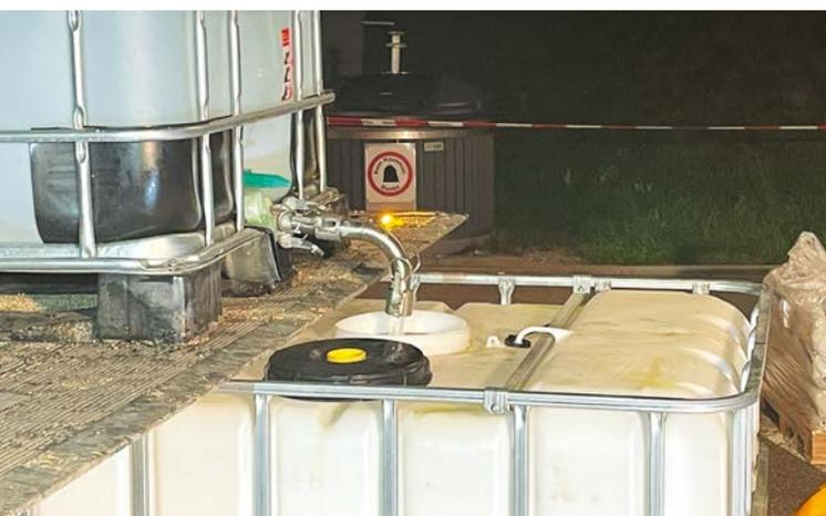
**Schwerkraftentleerung über das Bodenventil des Havaristen in einen Reservisten.**
