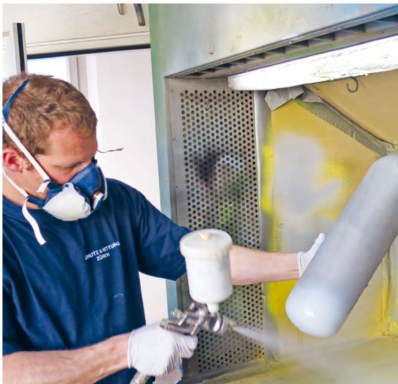
Wie neu: Atemschutzflaschen werden sandgestrahlt, gespritzt und lackiert
