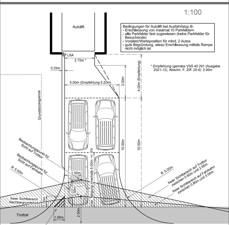
1x1m-Regel: absolutes Minimum der notwendigen Sicht aufs Trottoir (wenn die Gewährleistung einer grösseren Sichtweite unverhältnismässig wäre); freier Sichtbereich zwischen 0.80m und 2.65m
